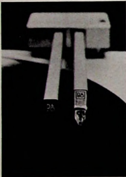
Bild 6: Tangential-Tonarmsystem des CD-4-Plattenspielers „Beogram 6000“ mit dem photoelektrischen Arm (links) und dem eigentlichen Tonarm (rechts) mit Hi-Fi-Tonabnehmersystem „MMC 6000“
