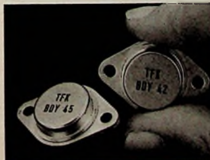
Bild 2: Neue Silizium-NPN-Leistungstransistoren BDY 42/43/44/45 (AEG-Telefunken)
