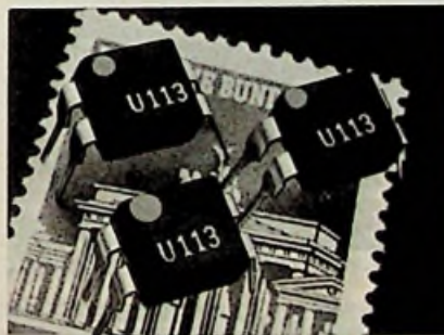
Bild 1: Monolithisch integrierter Berührungsschalter U 113 (AEG-Telefunken)
