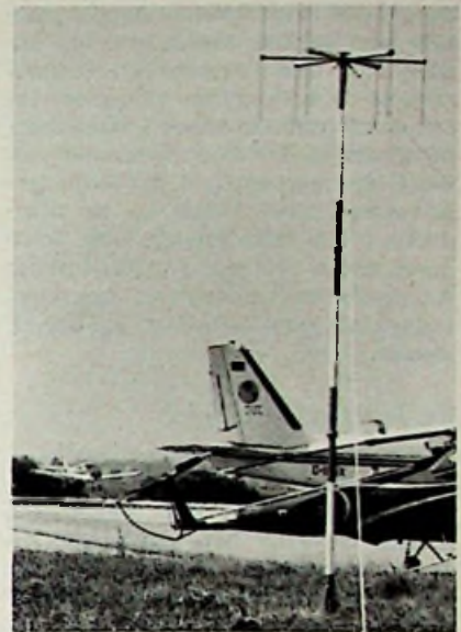
Bild 7: Betriebsfertig montiertes Peilantennensystem „AP 002“
